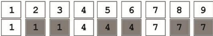
Figura 3.148. Funcionamiento del filtro estroboscópico
